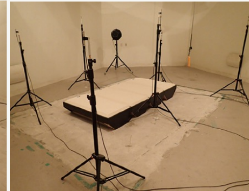
(b) 放置低音吸收器於樓板
